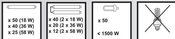
Lampe fluocompact avec ballast intégré/
